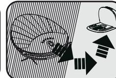
EL robot buscará un lugar claro cuando entre en un lugar de sombra durante la búsqueda de la estación de carga. Si no la detecta en 5 segundos, el robot se apagará automáticamente.
